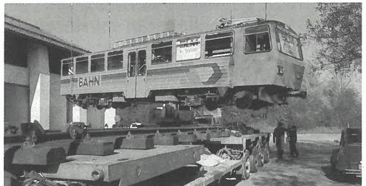
Einer der neuen Triebwagen der Wendelsteinbahn werden mit einem Mobilkran vom Straßentieflader auf das Gleis gesetzt. Foto: dbp/Schlecker
